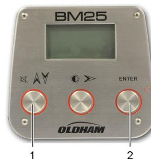
Figura 14: Pulse 1 y 2 para seleccionar el gas de calibración
